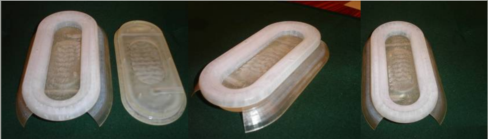
Fig.2, protótipo rígido em resina obtido por estereolitografia
