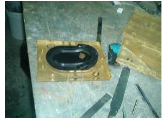
Fig.6 remoção da peça obtida
