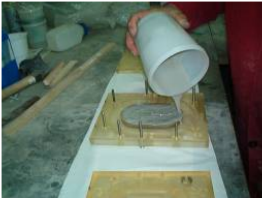
Fig.7 vazamento do silicone no molde
