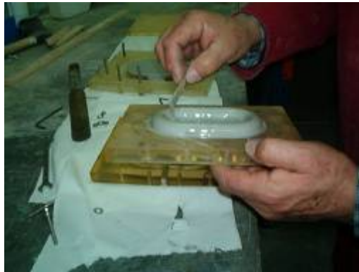
fig.8 garantir o preenchimento do silicone
