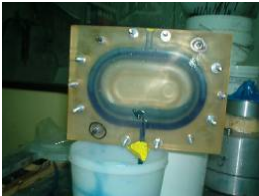
Fig.4 enchimento do silicone por vácuo
