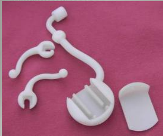
Peças desenvolvidas materializadas por prototipagem rápida
