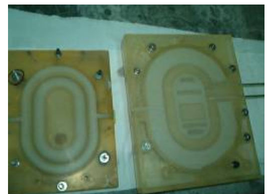
fig.9 fecho das duas metades do molde
