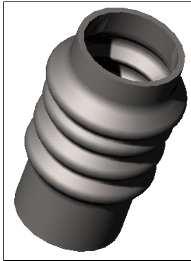
Figura 2-12: Representação esquemática do modo de esmagamento de um tubo metálico.
