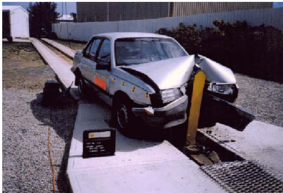
Figura 1-3: Ensaio de crash de um veículo automóvel (fotografia da Automotive Safety Engineering Pty Lda.).
