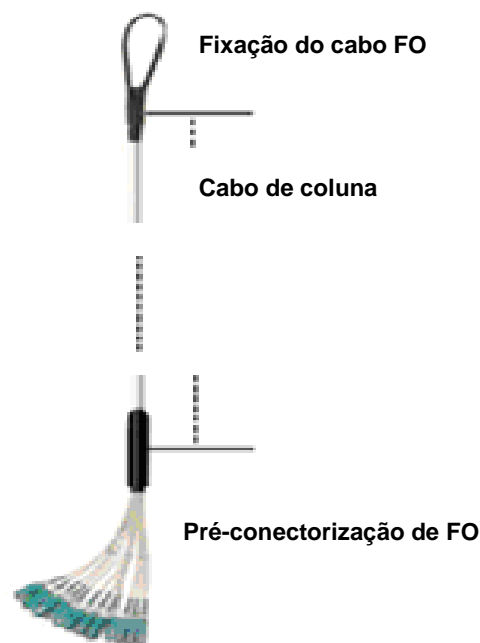
Figura 61 – Cabo de coluna de fibra óptica, pré-conectorizado
