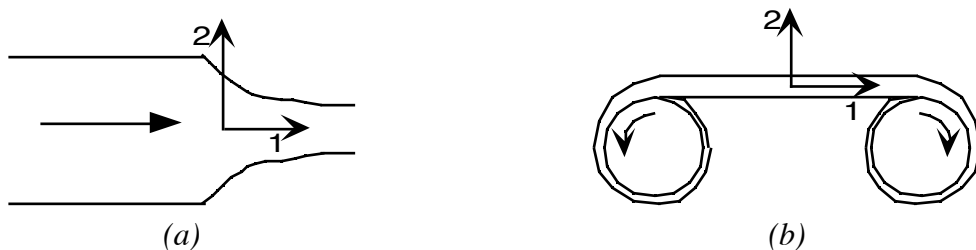
Figura 6- Representação esquemática de um escoamento com forte deformação extensional a velocidade de deformação ( \epsilon ) constante : a) Escoamento numa contracção gradual b) Extensão uniaxial.
