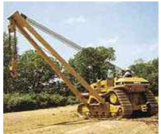
4 – Assentador de tubos
