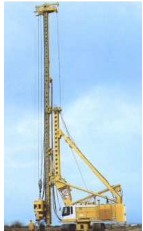
48 – Equipamento execução estacas
