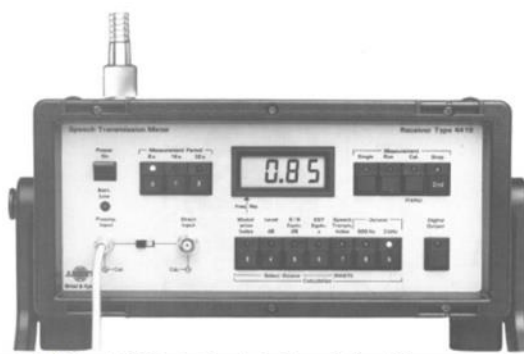
Fig. 5.2 - Equipamento de RASTI Brüel & Kjær, modelo 3361, constituído por um emissor modelo 4225 (esq.) e um recetor modelo 4419 (dir.) [40]
