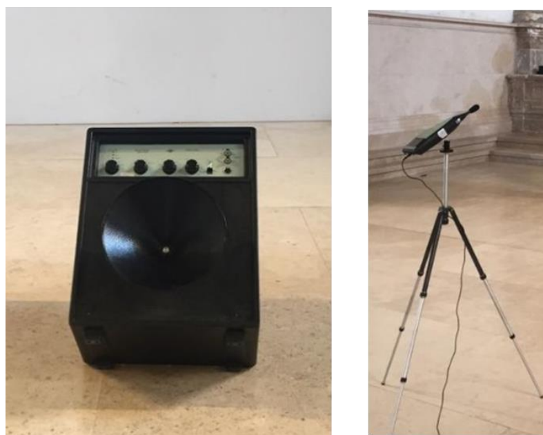
Fig. 5.9 - Fonte sonora B&K, modelo 4224 (esq.) e sonómetro B&K, modelo 2260 (dir.) [fotos do autor]
