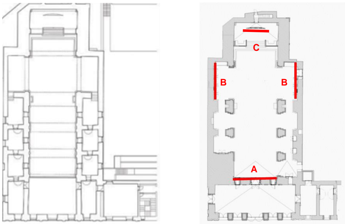
Fig. 4.14 - Planta da igreja de São Francisco, Coimbra, antes (esq.) [35] e depois da reabilitação [44] com a localização da colocação dos painéis absorvedores e difusores na parede traseira da plateia (A), dos painéis difusores sonoros de madeira (B) e do painel refletor sonoro no coro (C)
