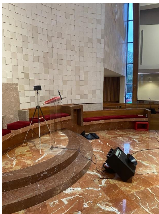
Fig. 5.6 – Posicionamento da fonte sonora Brüel & Kjær, modelo 4224 na igreja de Nossa Senhora dos Navegantes, para medição do tempo de reverberação [foto do autor].
