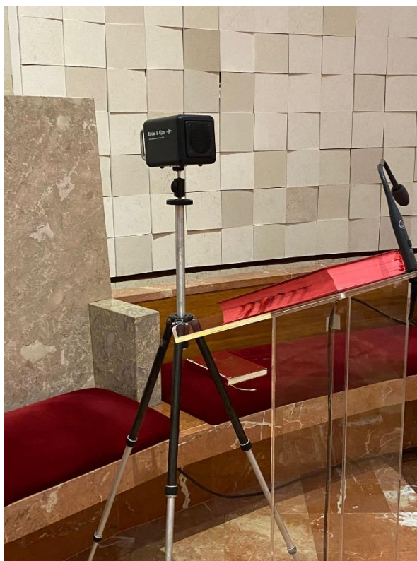
Fig. 5.8 - Fonte sonora Brüel & Kjaer ( Echo Speech Source ) modelo 4720 instalado na igreja de Nossa Senhora dos Navegantes [foto do autor].
