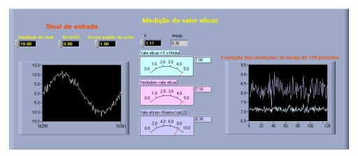
Este VI ilustra a medição do valor eficaz de um sinal sinusoidal, ao qual pode ser adicionado um valor DC e um ruído; são demonstrados três métodos alternativos para determinar o valor eficaz do sinal resultante.
