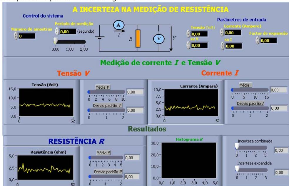
Com este instrumento virtual procura-se ilustrar a incerteza da medição -  $u_R$  - de uma resistência  $R$  através da medição de corrente  $I$  e tensão  $V$  no circuito da figura. As incertezas de  $I$  e  $V$ , são respectivamente,  $u_I$  e  $u_V$ .
