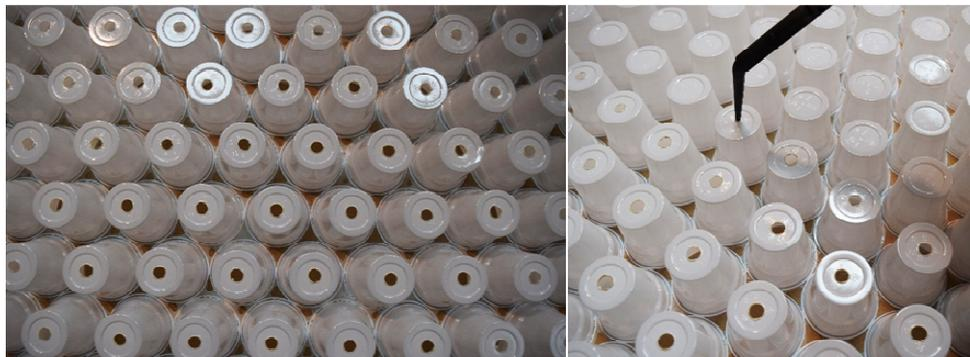
Figura 2 - Copos plásticos de café (CC<sub>f</sub>) em disposição quincôncio, furados na base com 10 mm de diâmetro
