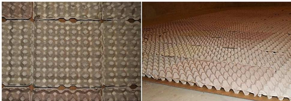
Figura 3 - Tabuleiros para ovos (TO) em celulose moldada com a face inversa exposta ao som
