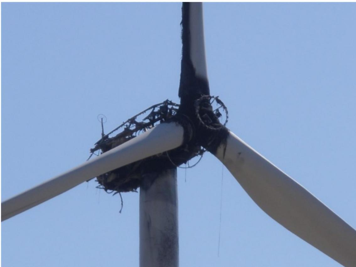
Fig. 1.6 – Danos causados pela DEA na *nacelle* do aerogerador atingido no parque eólico de Torres Vedras em 09/09/2009
