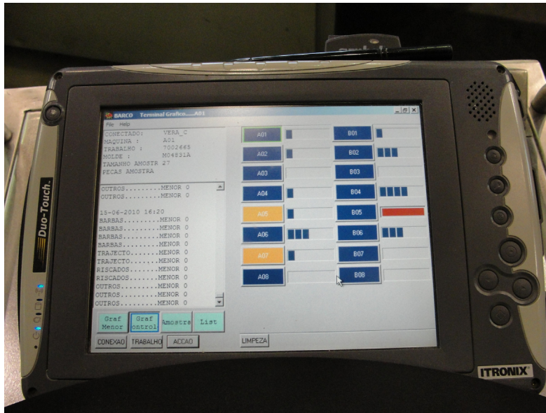
Figura 13 – Detalhe da evolução da máquina (barra azul, máquina sob controlo; barra vermelha, máquina fora de controlo).
