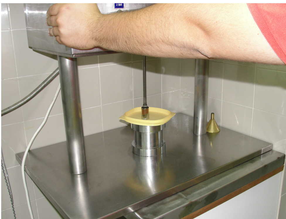
Figura 16 – Drop Test (rebentamento).
