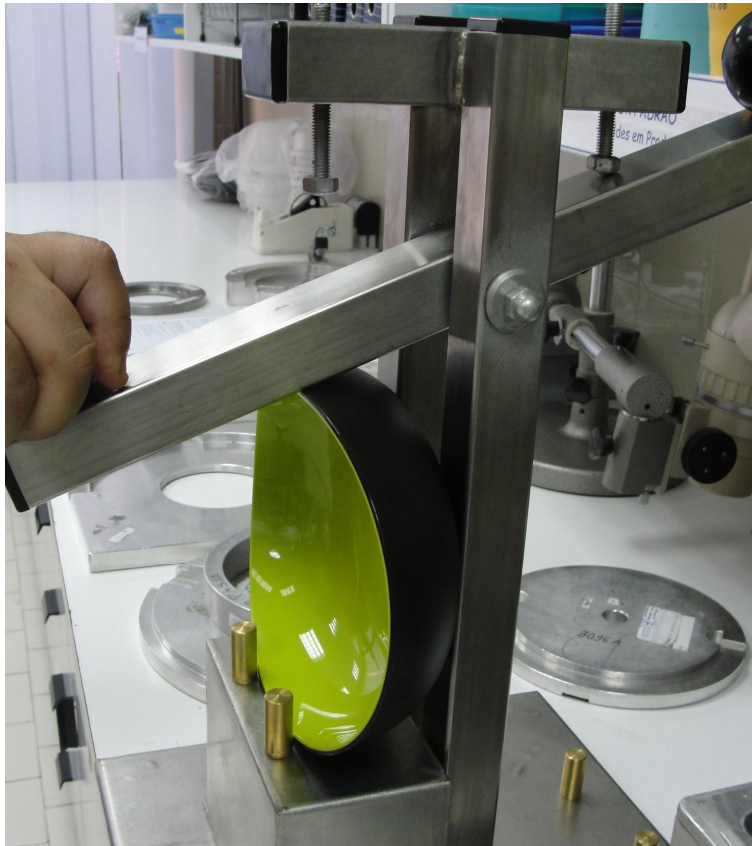
Figura 17 – Teste de adesão entre duas camadas da mesma peça.
