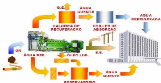
Fig .2. Esquema típico de representação – cogeração/trigeração (imagem extraída de [8]).
