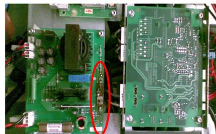
Fig. 11. Fonte de alimentação (à esquerda) com indícios de uso intenso com ventilação deficiente.
